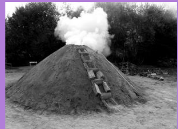
Carboneras para producir carbón vegetal a partir de madera
